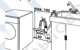
**▪** Чтобы грязная вода беспрепятственно уходила в канализацию и не попадала обратно в стиральную машину, конец шланга следует погружать в сливное отверстие не глубже, чем на 15 см. Если шланг слишком длинный, его нужно обрезать.
