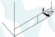
**!** Чтобы снять крышку фильтра, можно слегка прижать ее каким-либо инструментом с тонким пластиковым наконечником, вставив его в щель над крышкой. Не используйте для открывания крышки инструменты с металлическими наконечниками.
